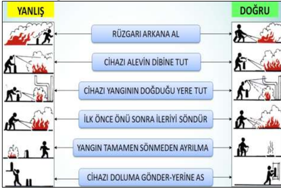
Şekil 40: Yangın Söndürme Cihazlarının Kullanılması
