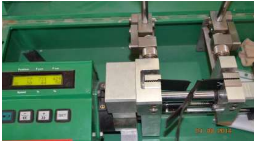
Şekil 8: Kayma Deneyi Detayı HDPE jeomembran da başarılı kaynak için asgari şartlar
