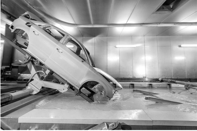
Şekil 3. Otomobil gövdesinin elektrokaplama yöntemi ile boyanması [7]
