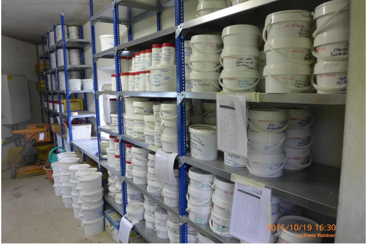
Şekil 12: Aşağı Avusturya'daki bir düzenli depolama sahasındaki şahit numune depolama tesisi
