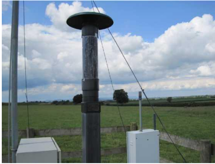
Şekil 11: Hava kalitesi izleme sistemi
