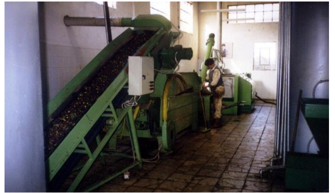
Fotoğraf B. 2-Kontinü Sistem İle Zeytinyağı Üretimi
