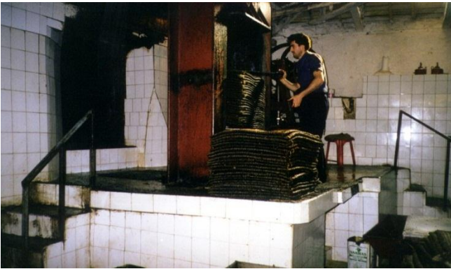
Fotoğraf B. 1-Sulu Baskı Yöntemi İle Zeytinyağı Üretimi
