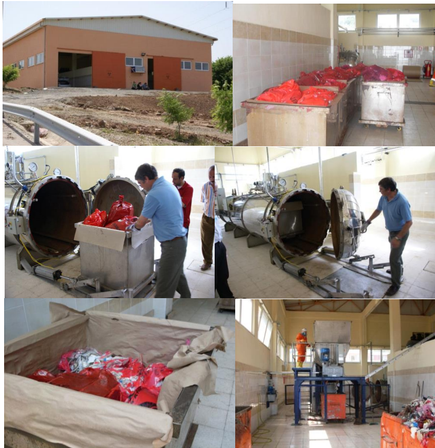
Resim C.1- Tıbbi Atık Sterilizasyon Tesisi Binası, Sterilizasyon Ünitesi, Parçalama Ünitesi
