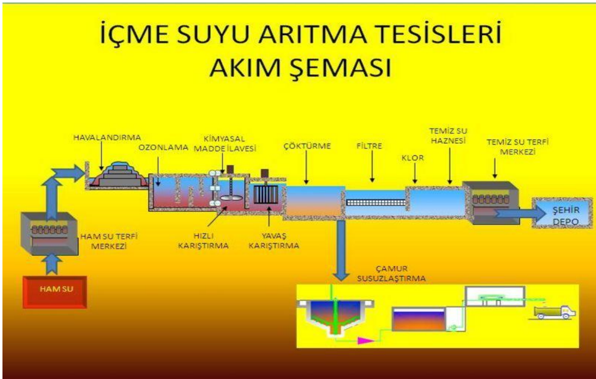
Şekil 1– Kars içme suyu arıtma tesisi akım şeması (Kars Belediyesi, 2015)
