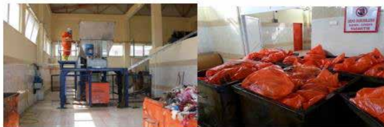
Fotoğraf 124- Tıbbi Atık Sterilizasyon Ünitesi, Parçalama Ünitesi
