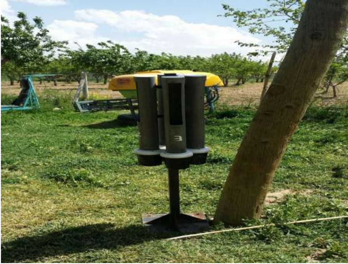
Şekil IV.2.15.6. Çöken Toz Ölçümlerinden Görünüm -2
