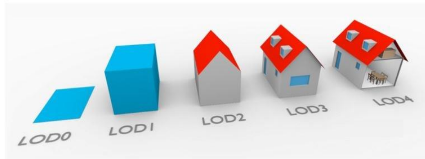
Şekil 35. CityGML' de Binaya ait Detay Seviyeleri
