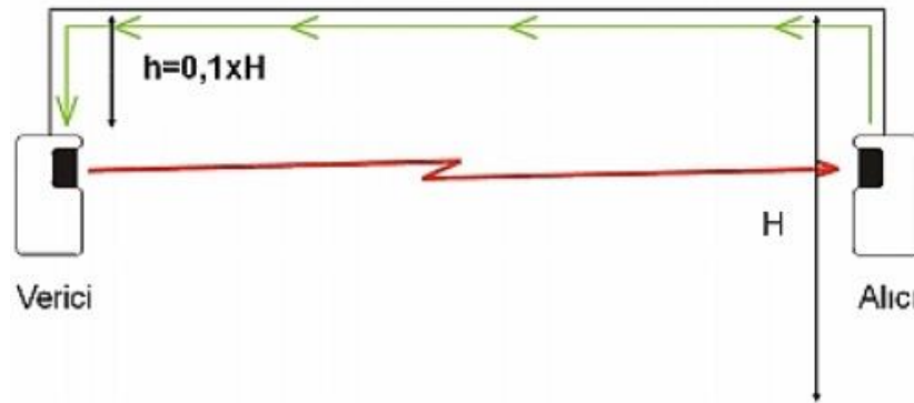
Şekil 4.5. Işın Tipi Dedektör ve Çalışma Durumu
